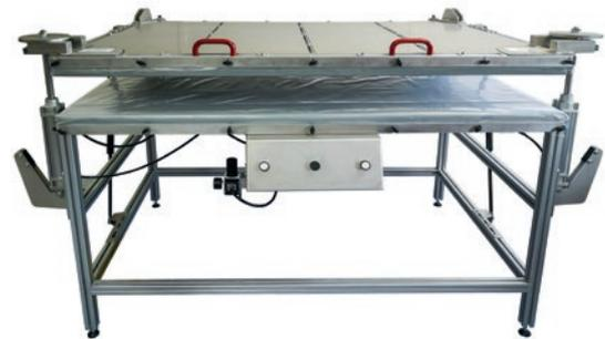
Das imprägnierte STK-Lab-Papier benötigt starken und gleichmäßigen Druck ohne Verschiebung gegen die analysierten Beweisstücke zu drücken. Diese Pressen machen die Arbeit im Labor einfacher und erzeugen reproduzierbare Ergebnisse.
